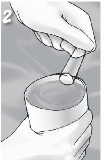
2. Sumerja el pequeño tubo (0125) en la muestra de agua. Con mucho cuidado, retire el tubo de la muestra de agua, manteniendo el tubo lleno hasta el tope.
