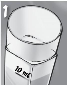
1. Llene el tubo de prueba (0106) con la muestra de agua hasta llegar a la línea de 10ml.
